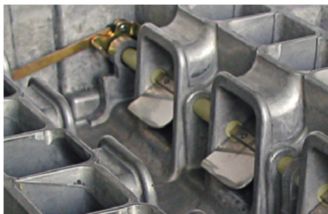
Przykład: przełączany kolektor dołotowy Mercedes-Benz V6 3,2 l
