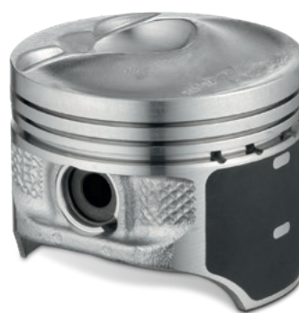
Fig. 5: Pistão da Kolbenschmidt com superfície do pistão especial para a operação de carga estratificada
