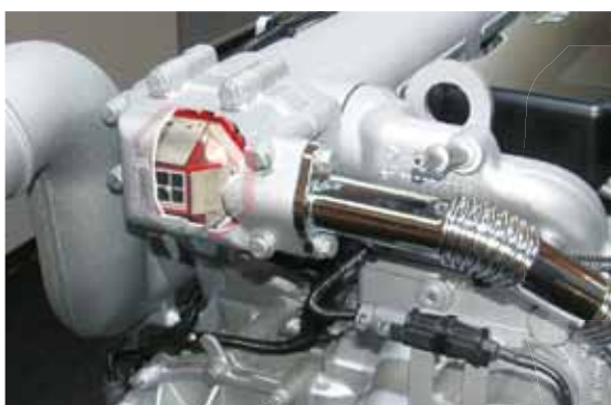
Обратный клапан на двигателе (оптически в разрезе)
