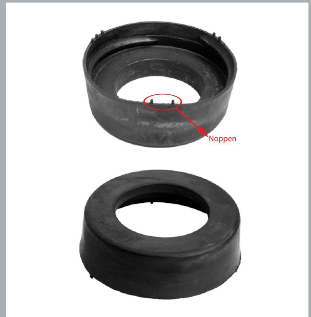
Bild 1: Beilage für Fahrwerksfedern
