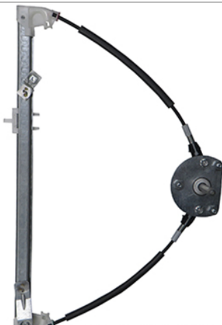
POWER WINDOW LEFT ALZACRISTALLI ELETTRICO SX
