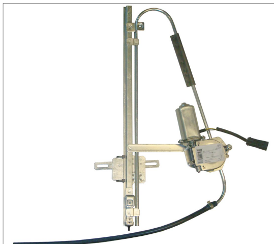
POWER WINDOW LEFT ALZACRISTALLI ELETTRICO SX
