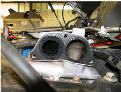
Coletor de admissão obstruído
