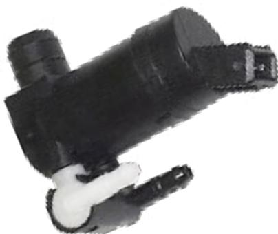
Eine nicht funktionierende Scheibenwaschpumpe zur Scheibenreinigung kann durch Kälte und dadurch gefrorenes Waschwasser oder zugefrorene Waschwasserdüsen beeinträchtigt werden. Auch die Scheibenwaschpumpe kann bei sehr niedrigen Temperaturen beispielsweise einfrieren. Die Scheibenwaschpumpe gehört zu den typischen Verschleißteilen eines Kfz und kann im Laufe der Zeit Defekte aufweisen.
