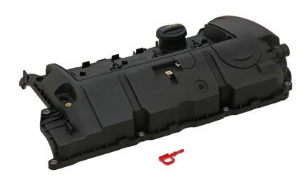
Der mitgelieferte rote Clip dient als Wartungswerkzeug und wird zur Montage der Zylinderkopfhaube nicht benötigt.
