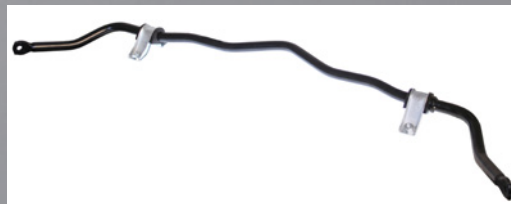
Bild 1: Stabilisator mit aufvulkanisierten Lagern
