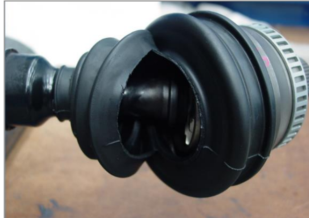
Bild 2 – Manschette reißt in den Lamellen ein
