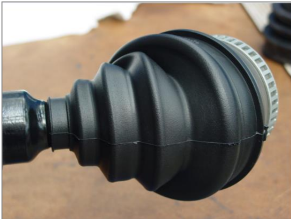
Bild 1 – Manschette zu weit aufgeschoben
