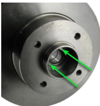
Achten Sie darauf, dass bei der Montage der Druck ausschließlich auf den Lagerinnenring ausgeübt wird.
