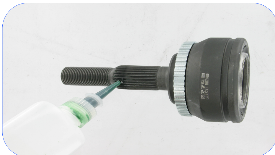
Abb. 1: Auftragen des Metallklebers
