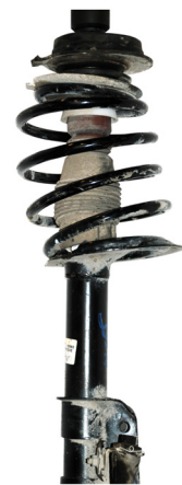
Falsch montierte Kopfplatte
