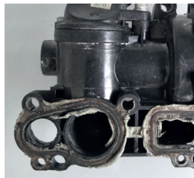
Abb. 5: Undichtigkeiten durch zusätzliche Dichtmittel (Schadensbild)
