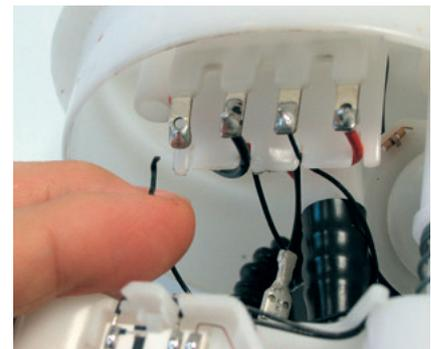
Abb. 3: Typisches Schadensbild: Das Kabel des Tankgebers ist lose und die elektrischen Kontaktfahnen sind verbogen.
