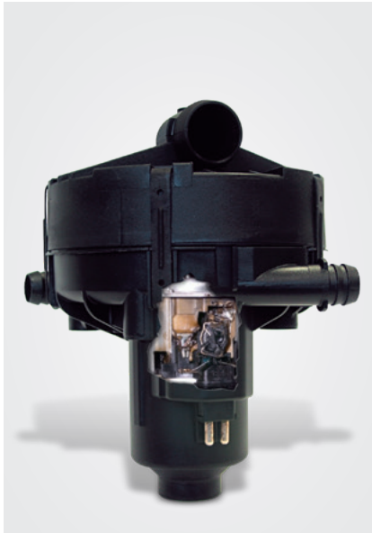
Blick in die Sekundärluftpumpe (geschnitten) mit Schmelzspuren
