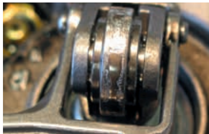
Schadensbild: Laufrolle mit Kerben (Pittings) durch verschlissene Kurvenscheibe
