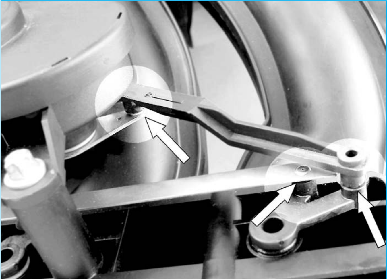
Verbindungsstellen zwischen EAM-i und Drallklappen
