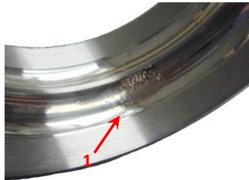
Un montage à l'envers du roulement entraîne une anomalie du calculateur ABS (code défaut, voyant ABS). Un remplacement par un roulement neuf est nécessaire. Lors du montage du roulement, bien vérifier que le côté équipé du codeur magnétique se trouve côté intérieur véhicule (côté capteur).
