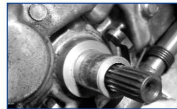
Verschlossene oder festsitzende Drehpunkte des Ausrückmechanismus / Festsitzender Kupplungszug / Verschleiß des Getriebeführungsstutzens
