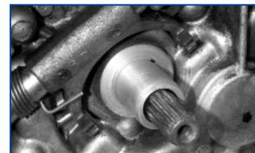
Schwungradverschleiß Getriebe-Fixierzapfen (fehlen oder sind beschädigt) / Verschleiß des Antriebswellenlagers (Bewegung)
