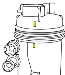
Ersetzen Sie die Gummidichtung zwischen den beiden Teilen des Gehäuses durch die mit dem neuen Filter mitgelieferte Dichtung. Bringen Sie den oberen Teil am Gehäuse an, indem Sie die gelben/grünen Markierungen aufeinander ausrichten.
