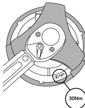
Ziehen Sie den Befestigungsring mit 30 Nm fest und bauen Sie das Gehäuse anschließend ins Fahrzeug ein. Schließen Sie dann alle Kraftstoffleitungen und elektrischen Stecker an. Starten Sie den Motor und prüfen Sie auf Undichtigkeiten.
