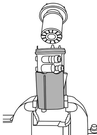
Ziehen Sie den oberen Teil des Filtergehäuses heraus und tauschen Sie das Kraftstofffilterelement (ADK82327) aus. Achten Sie dabei darauf, das Filterpapier des neuen Elements nicht zu berühren.
