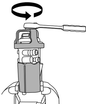
Lösen Sie den Befestigungsring, indem Sie Werkzeugteil "B" mit einem 1/2"-Ratschengriff gegen den Uhrzeigersinn drehen.
