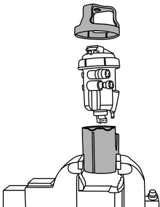
Spannen Sie Werkzeugteil "A" in einen Schraubstock ein. Bauen Sie das Kraftstofffiltergehäuse aus dem Fahrzeug aus. Achten Sie dabei darauf, alle Leitungen und elektrischen Stecker abzuziehen. Stecken Sie das Filtergehäuse in das Werkzeugteil "A" und setzen Sie das Teil "B" oben auf das Gehäuse. Achten Sie dabei darauf, die sechs Nuten des Werkzeugs mit dem Befestigungsring des Filtergehäuses auszurichten.
