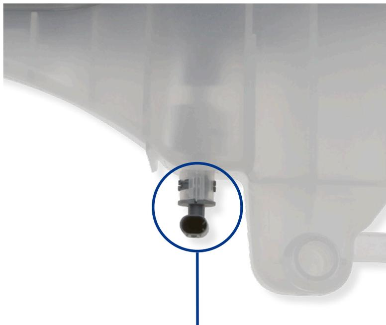
Quando si sostituisce la vaschetta espansione liquido refrigerante, assicurarsi di aver rabboccato il liquido e di verificare che non ci siano perdite dai manicotti. Infine ricordarsi di connettere il sensore di livello.
