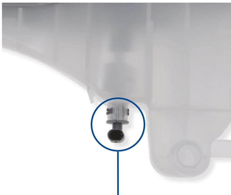
Nach dem Austausch des Kühlerausgleichsbehälters muss das Kühlsystem mit dem korrekten Kühlmittel aufgefüllt werden. Nach dem anschließen der Kühlmittelschläuche müssen diese auf Undichtigkeiten überprüft werden. Stellen Sie sicher, dass der Füllstandssensor verbaut wurde.
