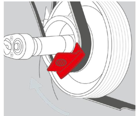
1. Positionieren Sie das Montagewerkzeug über der Kurbelwellenriemenscheibe und führen Sie den Riemen über die Vorderkante des Werkzeugs.
