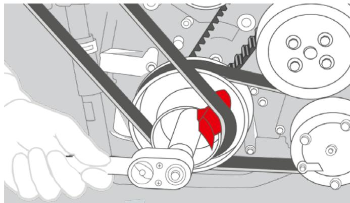
1. Positionieren Sie das Demontagewerkzeug zwischen der Riemenscheibe und dem Keilrippenriemen, wie abgebildet.
