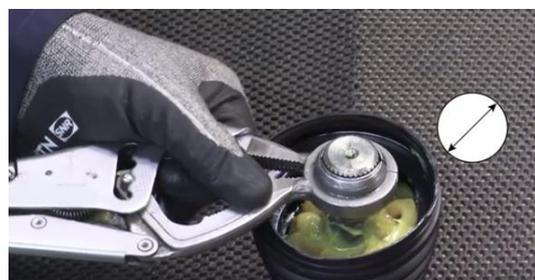
**4** Mise en place du bol sur l'arbre en 3 phases
