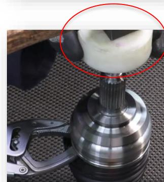
**Note :** L'utilisation d'une protection entre la masse et le bol évitera la détérioration du produit
