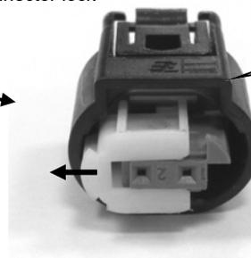
2. Original Leitung in die mitgelieferte Buchse mit Abdichtungen ganz einschieben und einrasten. Pinposition / Kabelfarbe ist nicht relevant. Anschließend Steckergehäuse verriegeln.
