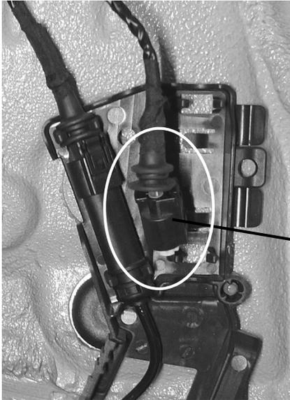
1. Steckersicherung öffnen. Original Steuerleitung zum Dämpfer mit geeignetem Werkzeug aus der Buchse ausspinnen.
