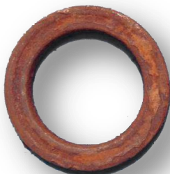
Soufflet détérioré : Butée de suspension corrodée suite à l'entrée de pollutions
