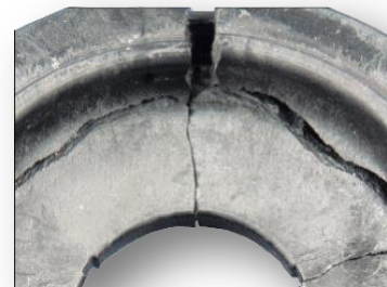
Butée de choc défectueuse : Support ressort de la butée de suspension rompu
