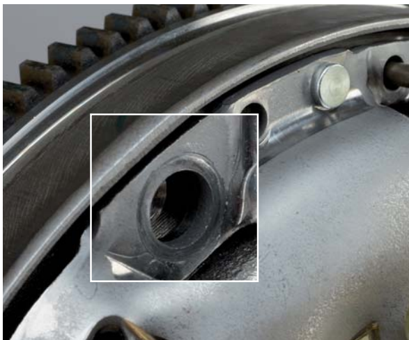
Druckplattengehäuse liegt nicht am Schwungrad an
