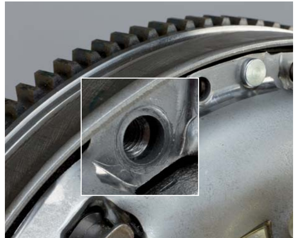
Druckplattengehäuse liegt am Schwungrad an
