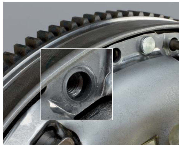
Druckplattengehäuse liegt am Schwungrad an
