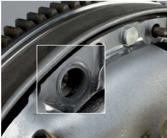
Druckplattengehäuse liegt nicht am Schwungrad an
