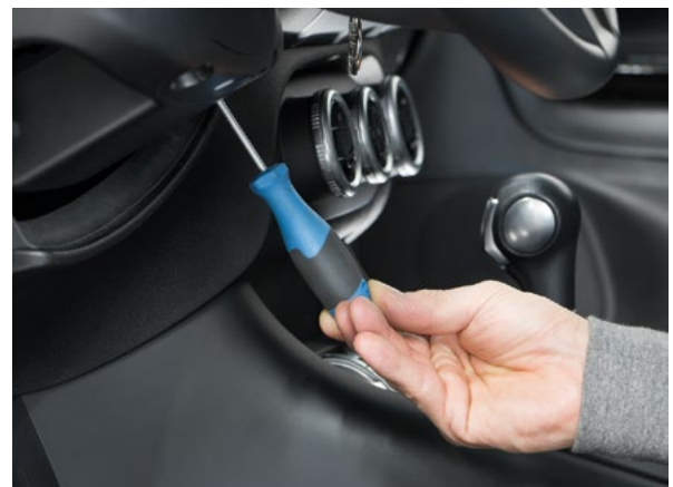
Die Zündschlüssel-Abzugssperre kann mit einem Schraubendreher außer Kraft gesetzt werden
