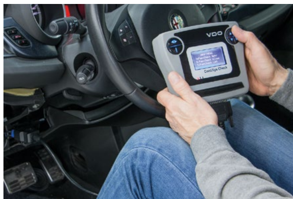
Grundeinstellung mit einem geeigneten Diagnosegerät
