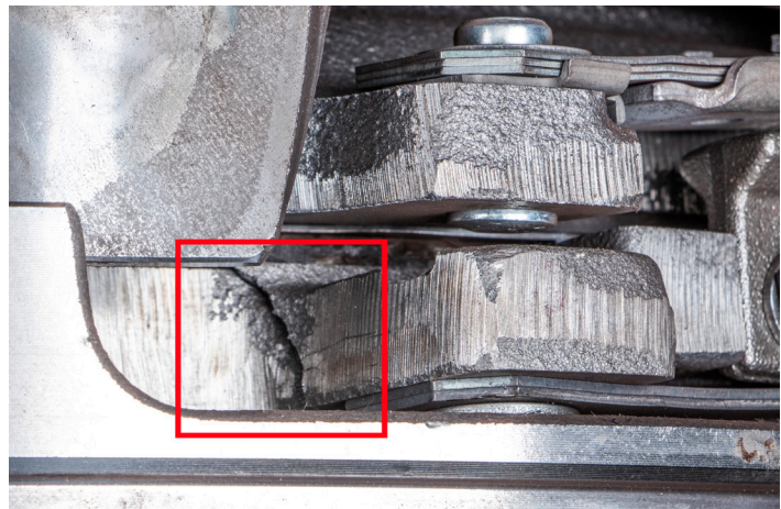
Bild 1: Nockenbruch an der Aufnahme der Tangentialblattfeder
