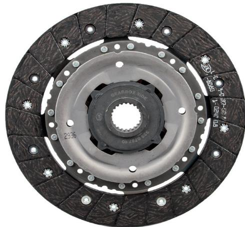
Bild 1: Kupplungsscheibe des LuK RepSet (Durchmesser 228mm)
