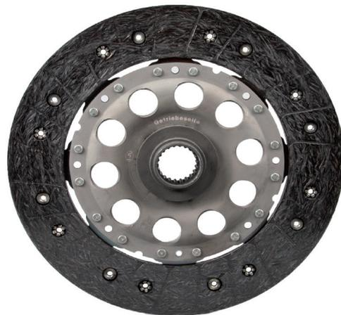
Bild 2: Kupplungsscheibe der Erstausrüstung (Durchmesser 240mm)
