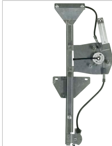
POWER WINDOW LEFT ALZACRISTALLI ELETTRICO SX
