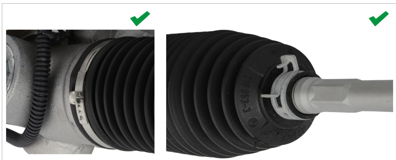
Fig. 5: Sin derivación: estanqueización correcta con abrazaderas de metal
