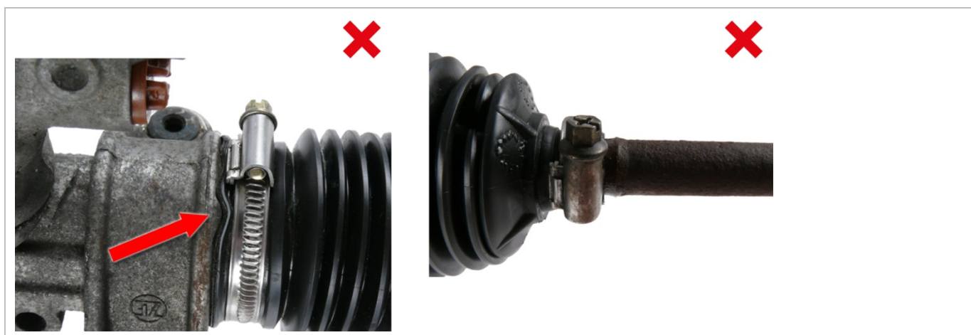
Abb. 6: Bypass: Mangelhafte Abdichtung mit Schlauchschellen
