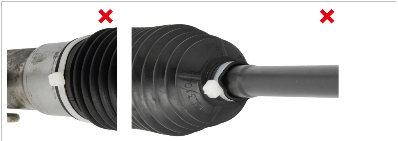
Fig. 7: Derivación: estanqueización deficiente con sujetacables
