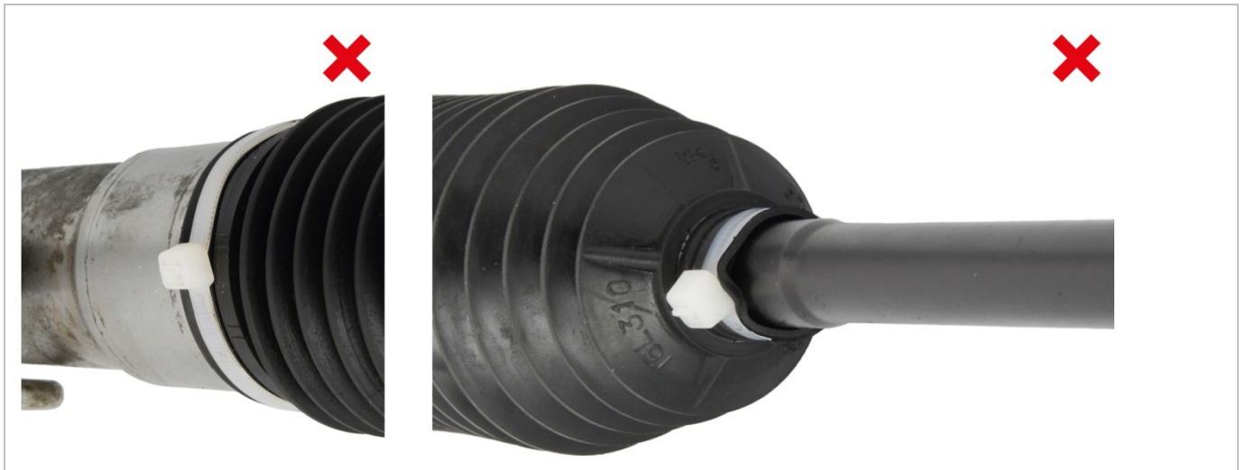
Fig. 7: By-pass : étanchéité défectueuse avec attache-câbles
