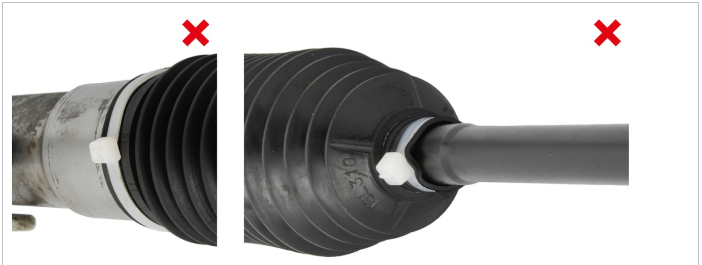
Abb. 7: Bypass: Mangelhafte Abdichtung mit Kabelbindern
