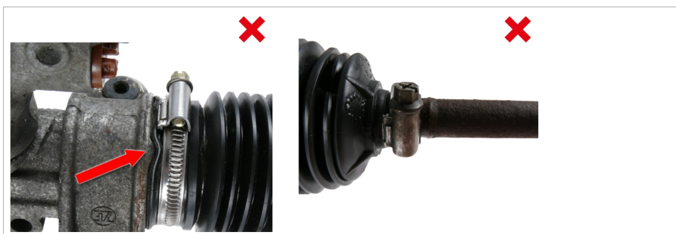
Fig. 6: Derivación: estanqueización deficiente con abrazaderas
