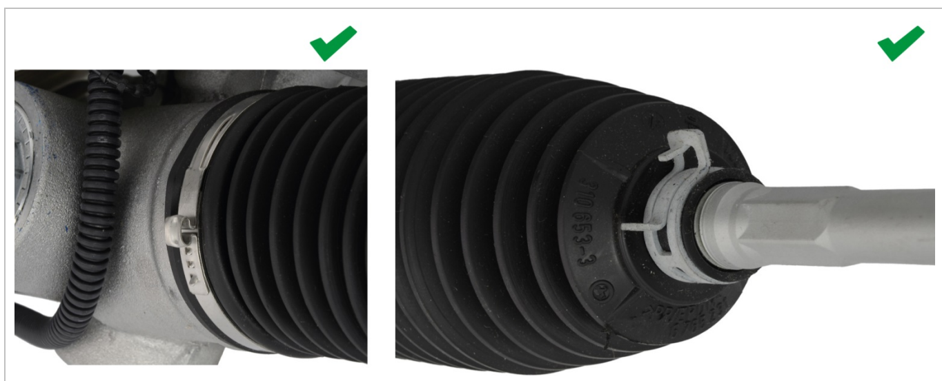
Abb. 5: Kein Bypass: korrekte Abdichtung mit Metallschellen
