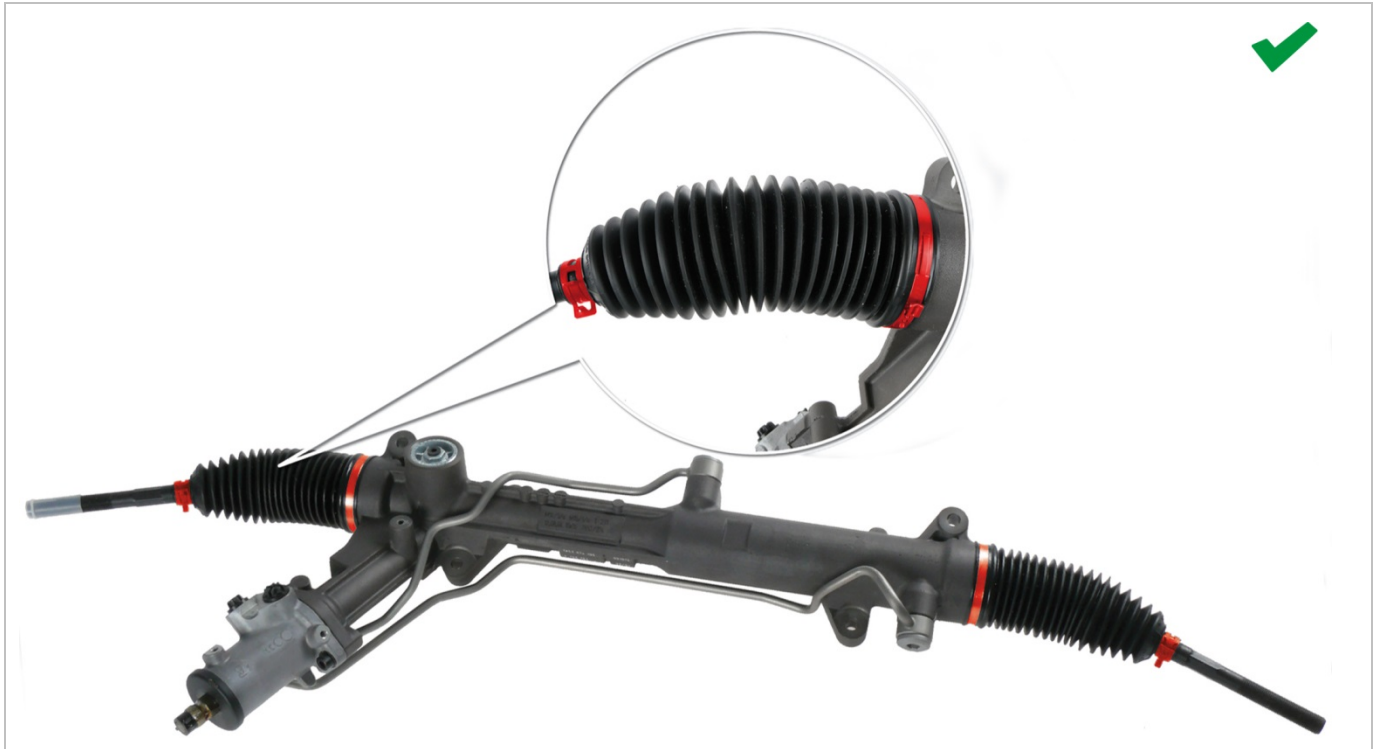
Abb. 1: Lenkgetriebe mit hydraulischer Lenkkraftunterstützung: korrekt montierte Lenkmanschetten
