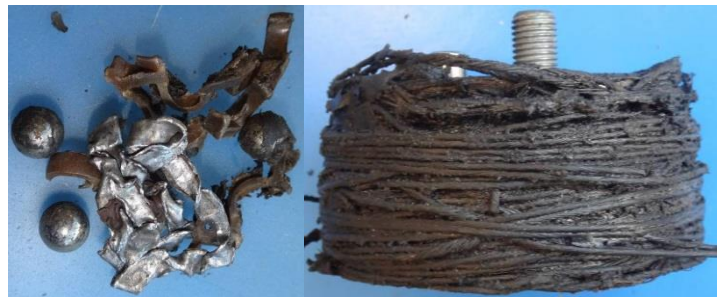
Conséquences glissement de courroie
