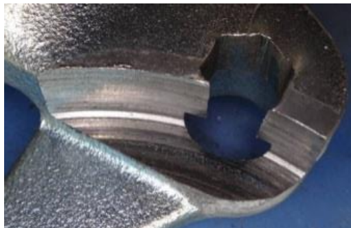
Trace d'abrasion par contact du galet
