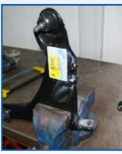
4. Per la protezione contro la corrosione è necessario coprire il metallo esposto.
