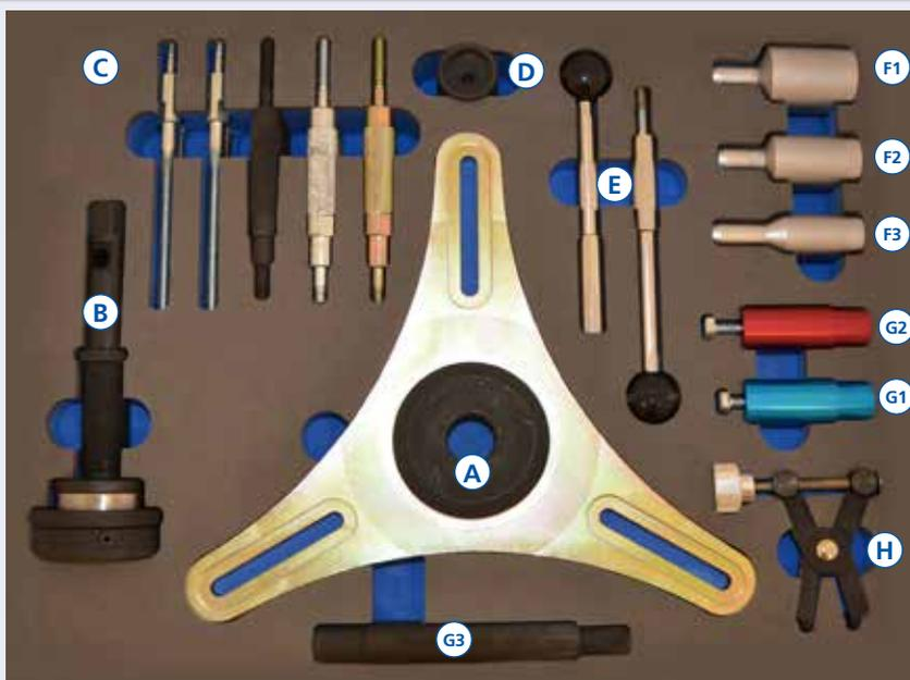
**L'attrezzo Blue Print per frizione auto-regolante (SAC) è un utensile essenziale per garantire il corretto montaggio della frizione stessa. Se durante l'installazione viene applicata una forza contrastante, il kit frizione provoca una rotazione accidentale nell'anello di regolazione, il risultato è una frizione regolata in maniera errata.**
