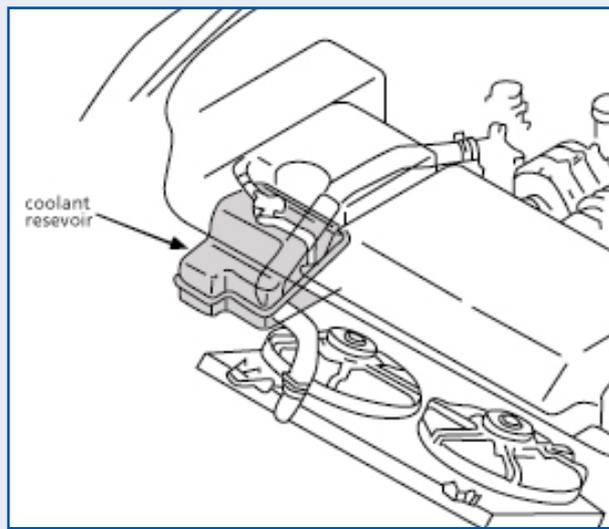
**Nota:** è necessaria estrema cura nella rimozione del manicotto refrigerante mostrato in figura per evitare di danneggiare il radiatore.
