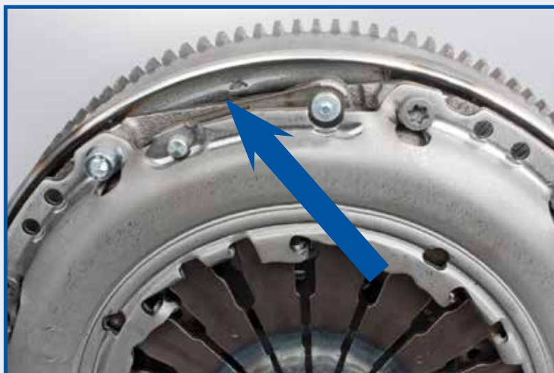
Abbildung 1: Materialabnutzung durch Einsatz von zu langen Schrauben
