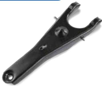
Wir haben festgestellt, dass die Ursache des Problems ein Riss in der Kupplungsausrückgabel sein kann. Bei diesem Modell kann sich die Ausrückgabel während des Betriebs biegen oder auch brechen. Somit wird verhindert, dass die Kupplung vollständig ausrückt.
