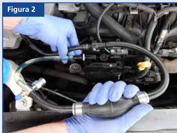
Kit spurgo sistema di alimentazione, installato e pronto per l'uso.
