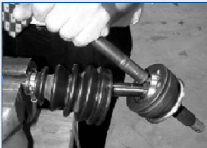
Rimozione del giunto originale
