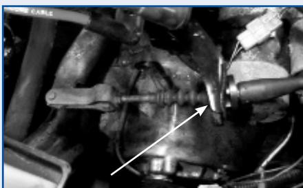
Bloccaggio del cavo della frizione
