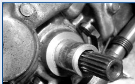
Usura della guida tubolare della trasmissione
