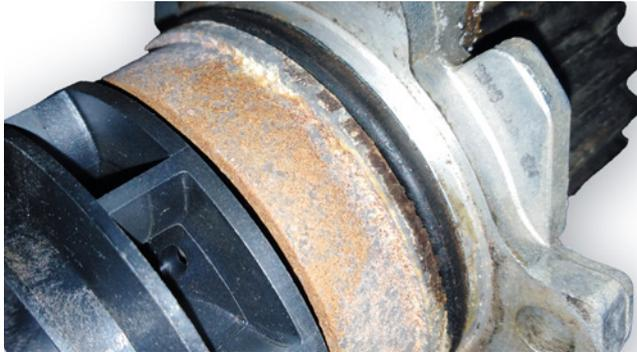
Bild 1: Korrosionsspuren an einer Kühlmittelpumpe
