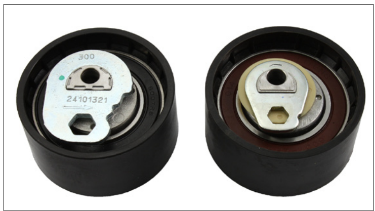
Bild 1: 531 0505 10 – Alte Ausführung (links) und neue Ausführung (rechts)
