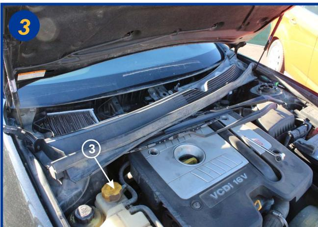
Déboîter le carter de ventilation du côté passager (3) il n'est pas nécessaire de l'extraire totalement.
