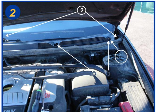
Retirer les essuies-glace: pour cela retirer à l'aide d'un tournevis plat les caches puis les écrous de 14 mm.
