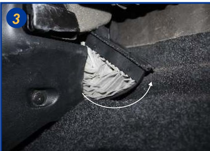
Sortir l'élément filtrant usagé en exerçant un arc de cercle pour pouvoir dégager l'ensemble du bloc filtrant. (voir flèche)
