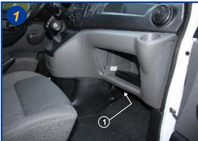
Le filtre habitacle est situé à l'intérieur du véhicule, côté passager derrière la console centrale (1).
