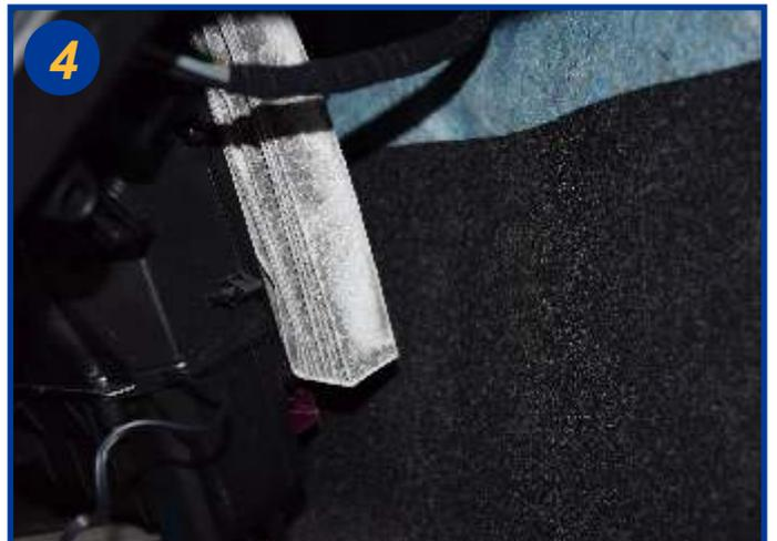
Sortir le filtre usagé du boîtier et procéder à son remplacement . Le remontage s'effectue dans l'ordre inverse du démontage.
