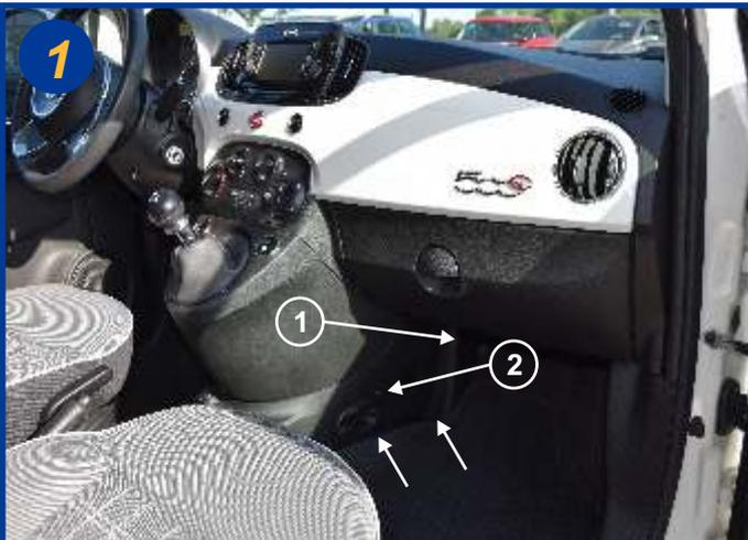
Le filtre d'habitacle est situé à l'intérieur du véhicule, coté passager coté console centrale (1). Dévisser la vis Torx (T25) sur le flan de console (2) et dégraffer celui-ci par le bas (voir flèches).
