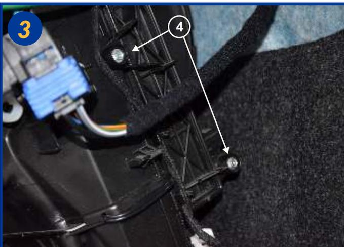
Dévisser ensuite les 2 vis hexagonales de 5,5 (4) pour extraire le couvercle du boîtier filtrant. Ouvrir le boîtier filtrant.
