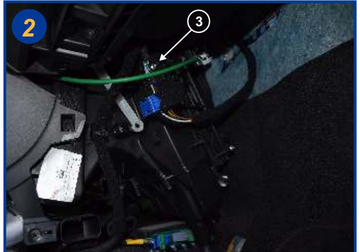
Dévisser ensuite la vis hexagonale de 5,5 (3) et déplacer le bloc de connexion sur le coté pour avoir accès aux vis du boîtier filtrant.
