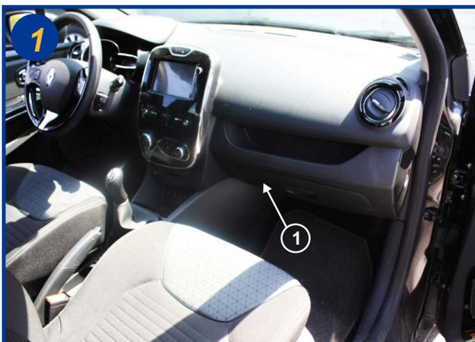
Le filtre habitacle est situé à l'intérieur du véhicule, côté passager derrière la boîte à gants coté console (1).
