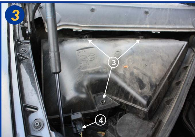
Dévisser également d'un quart de tour les 3 écrous plastiques de 13 mm (3). Il n'est pas nécessaire de débrancher l'indicateur de colmatage (4).
