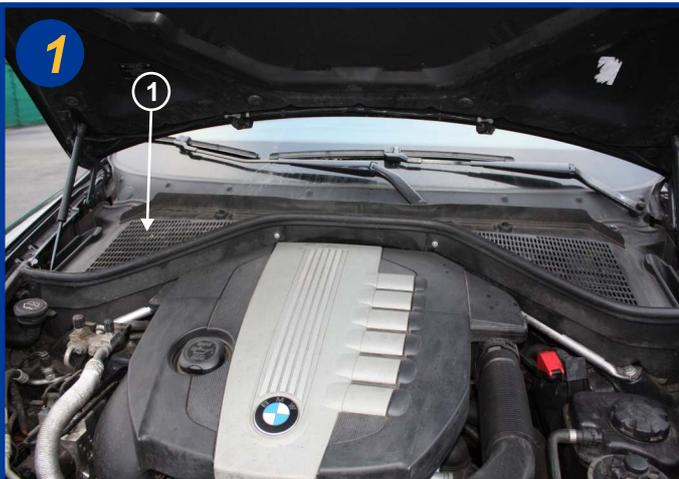
Les filtres d'habitacle sont situés sous le capot moteur, côté passager devant la baie de pare brise (1). Ouvrir le capot moteur.
