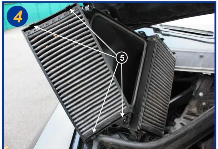
Sortir le boîtier filtrant et le retourner, faire attention de ne pas endommager l'indicateur (4). Dé-encliqueter les filtres usagés (5) et procéder au remplacement. Le remontage s'effectue dans l'ordre inverse du démontage.
